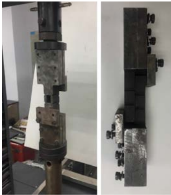
图 3 Z-pin 增强复合材料开孔层合板压缩试验夹具及加载装置
